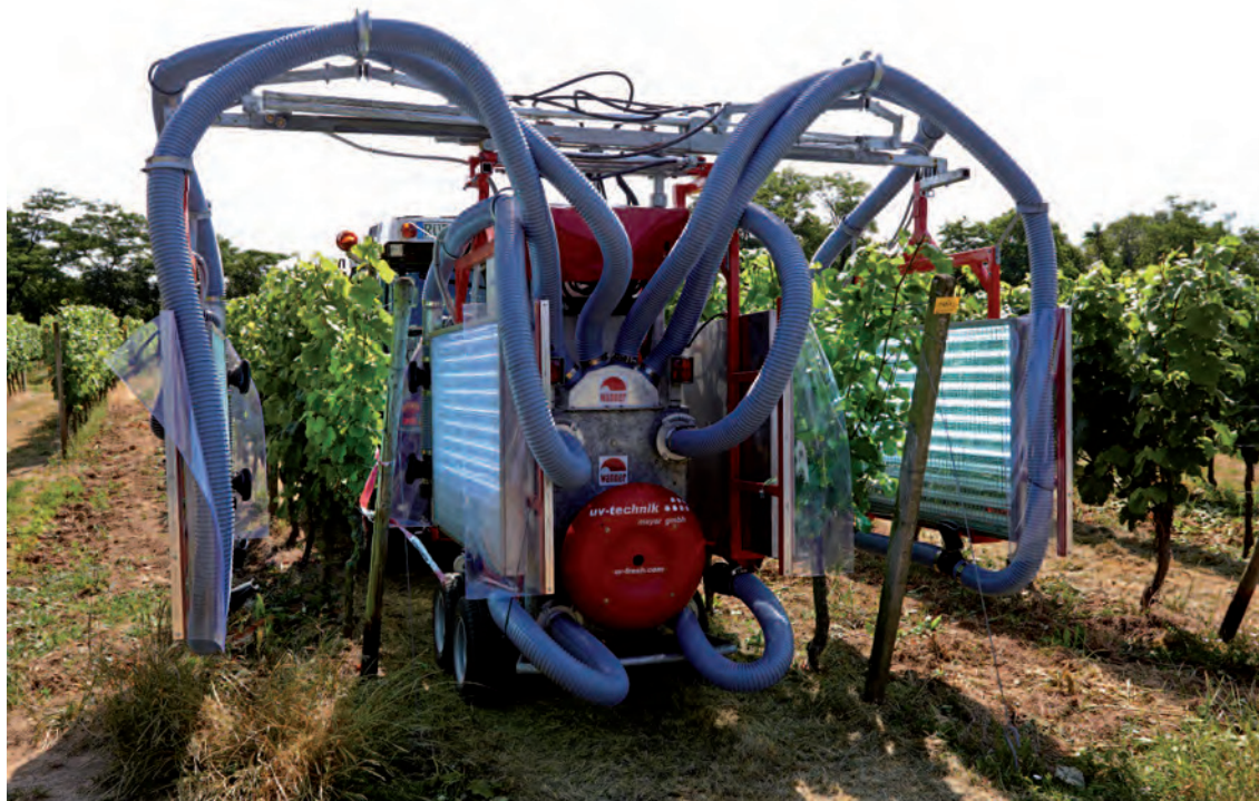
UV C-Prototyp für Freilandversuche im Weinberg und Gebläse zur Verwirbelung der Blätter zwischen den Modulen, um Abschattungseffekte zu reduzieren. (Bild: Winfried Schönbach)
