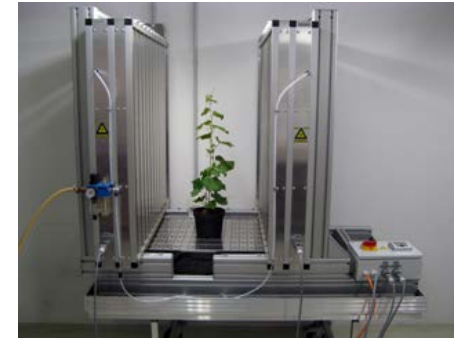
UV C-Bestrahlungseinheit für Versuche im Gewächshaus. Durch eine sekundengenaue Programmierung der Öffnungszeiten der Lamellen können reproduzierbare Bestrahlungsdosen appliziert werden.
